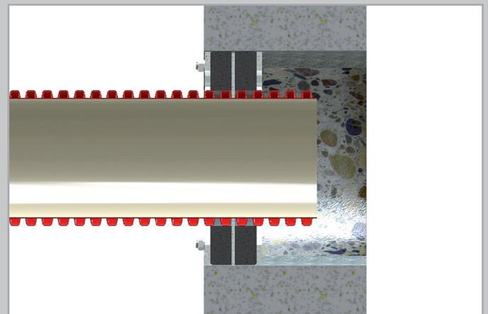
**Der Dichtungseinsatz RRD-WR für Wellrohre wird in geteilter Ausführung geliefert.**
